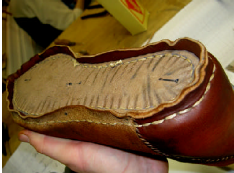
Fertig genähte Sohle (deutlich sieht man die Abdrücke der Nägel)
